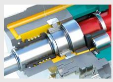
Благодаря высокоэффективной, уникальной конструкции NETZSCH (HEUD) осевые силы в насосе уравновешены.
