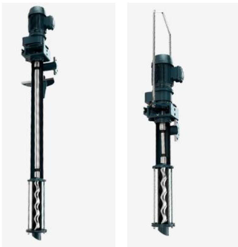
В отдельных случаях вязкость сырой нефти настолько высока, что она не может засасываться горизонтально установленным насосом. Здесь предлагается вертикальная конструкция винтового насоса NETZSCH как оптимальное решение. Эта конструкция имеется также в наличии как насосы Caisson и отличаются самыми низкими значениями NPSH.
