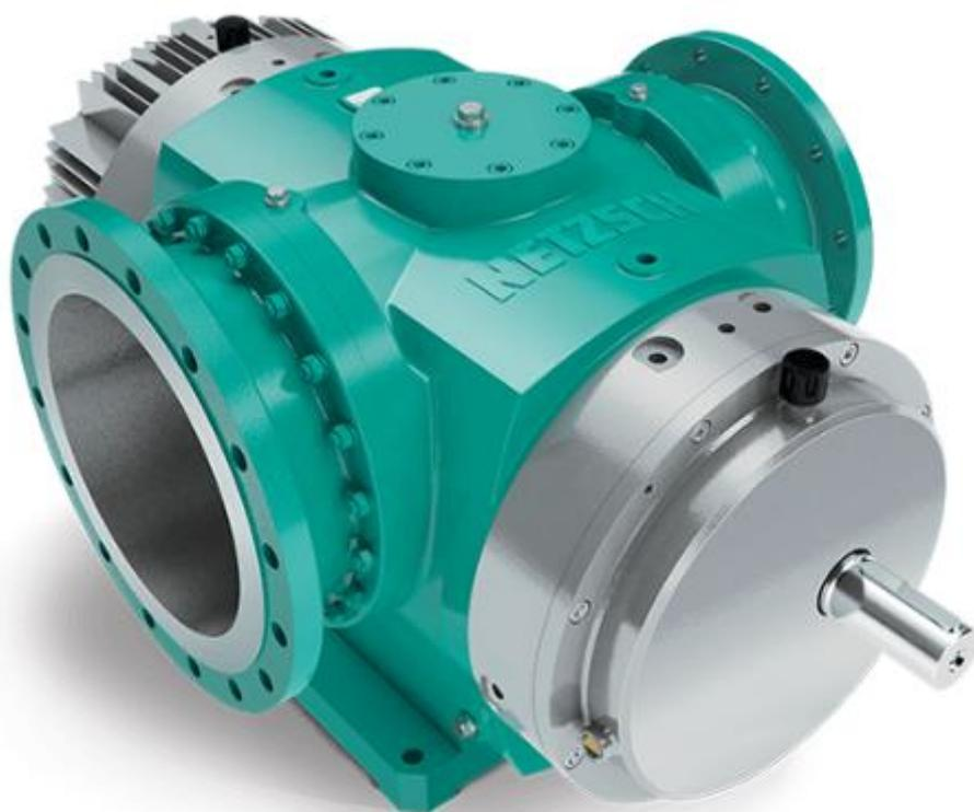
Двухвинтовые насосы NOTOS<sup>®</sup> с редуктором имеют два вала с четырьмя винтами. Синхронизирующие шестерни редуктора передают крутящий момент от одного вала к другому. Данная конструкция гидравлически уравновешена.
